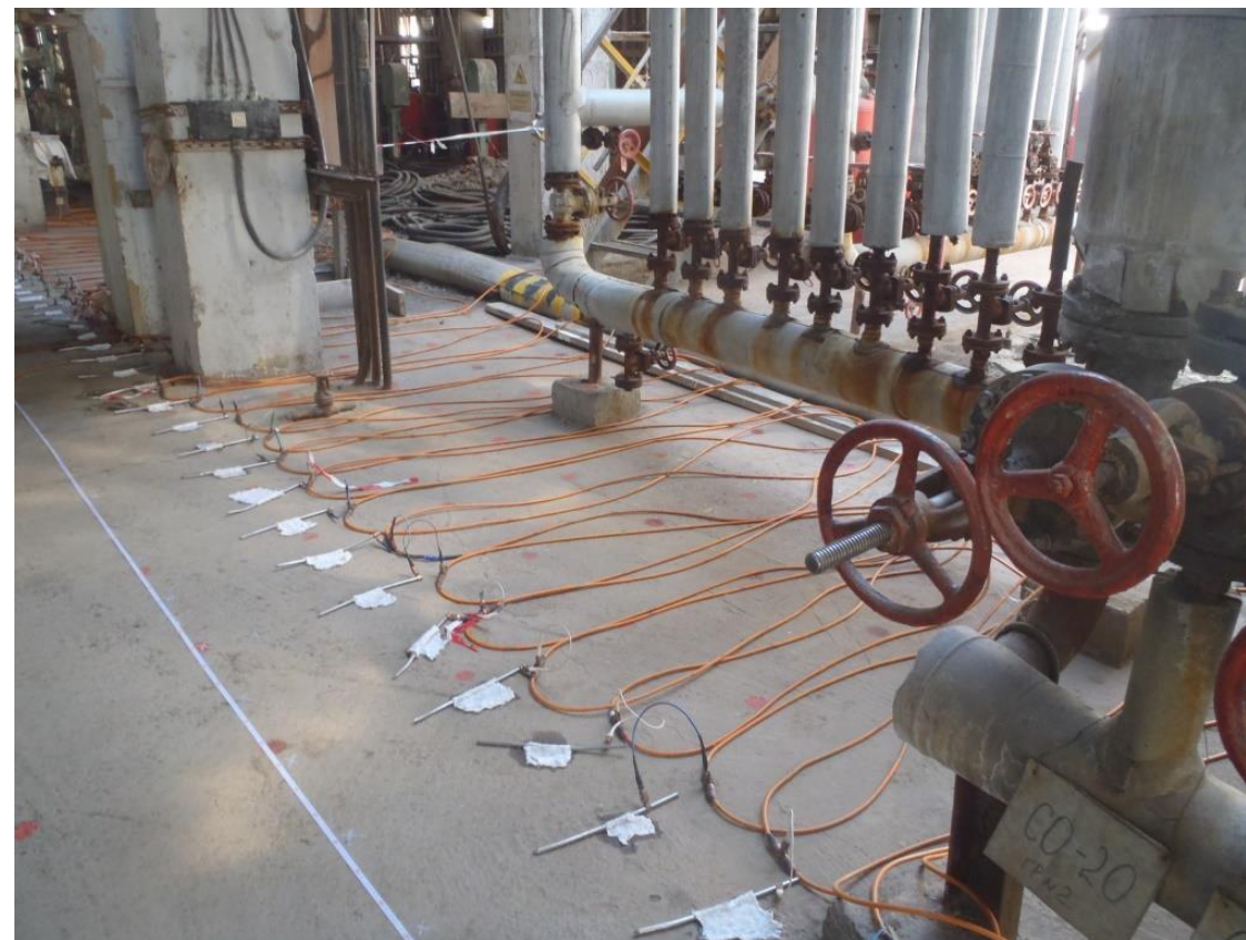
Фото заземления электродов на бетонной поверхности (фото сделано на участке №2)
