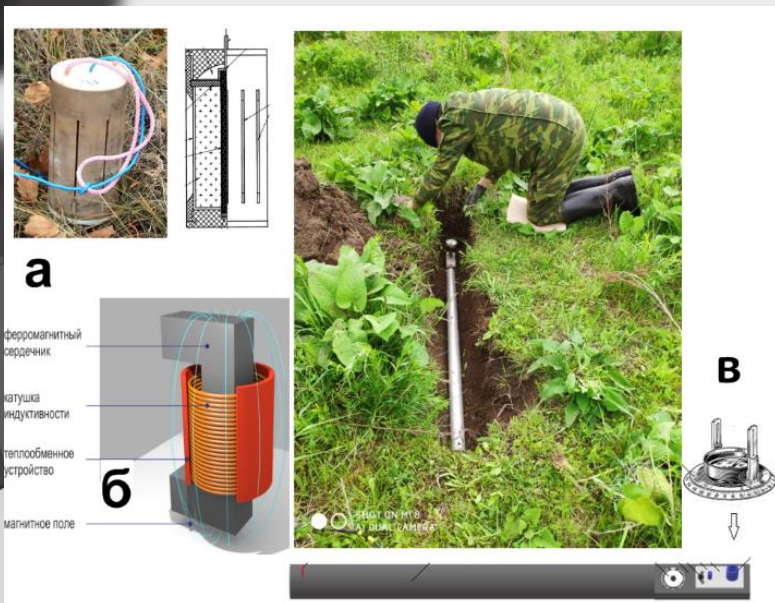
Широкополосная аппаратура Феникс MTU-5D Канадской компании Phoenix Geophysics
