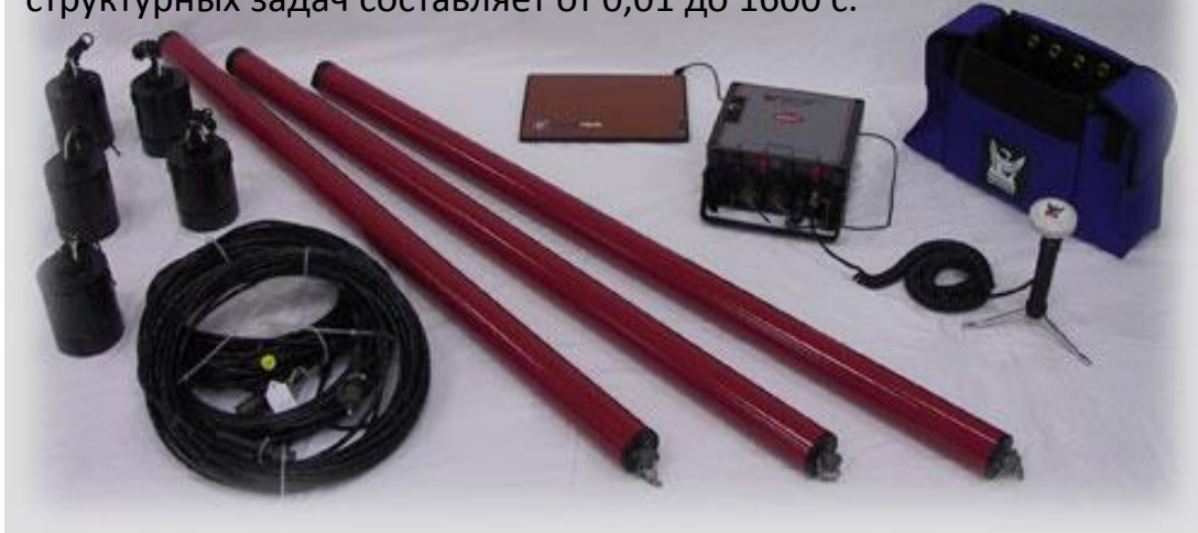
Широкополосная аппаратура Феникс MTU-5D Канадской компании Phoenix Geophysics
